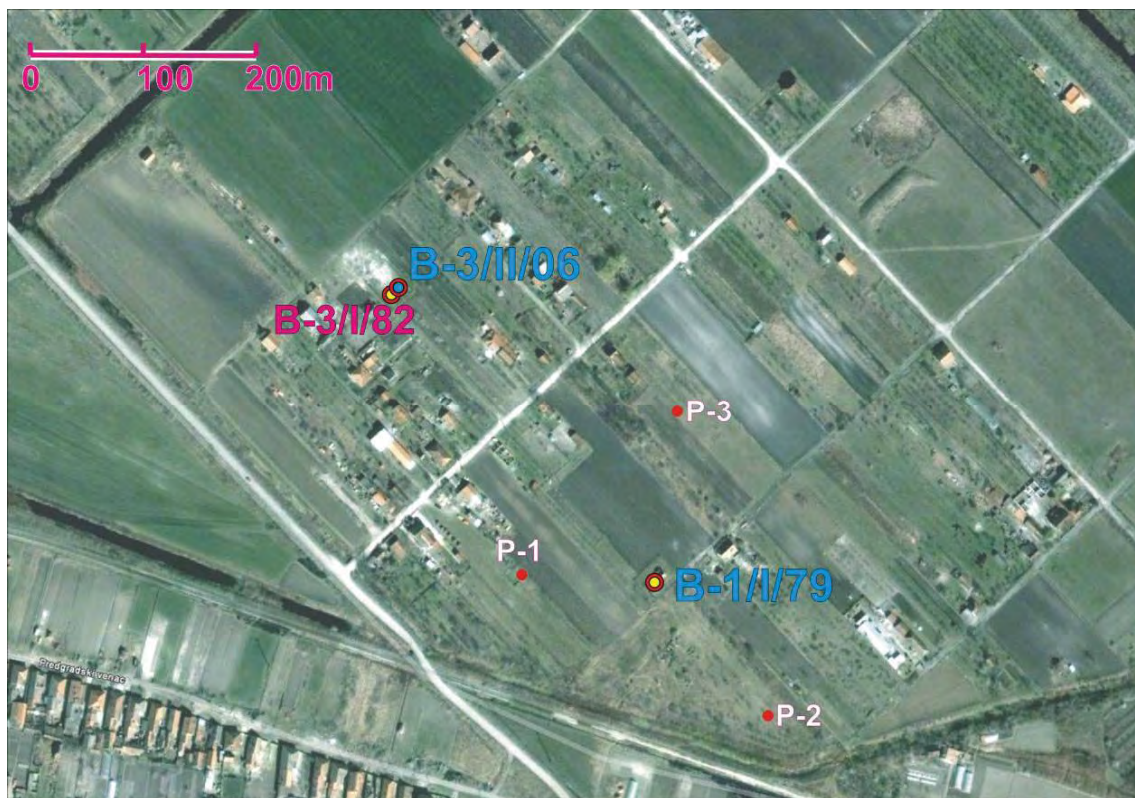
Slika 10. Izvorište SEVER – raspored objekata
